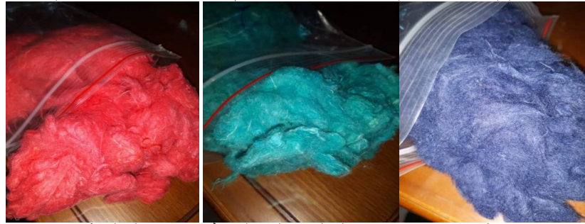
شكل (8) يوضح بعد مرحلة الفرم والكرد لبقايا أقمشة تم فصلها لونياً
