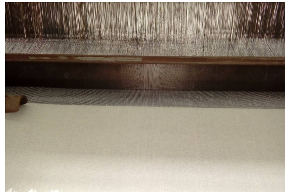
شكل (14) يوضح مرحلة النسيج لنمرة 1\20 ( للغزل المعاد تدويرها)
