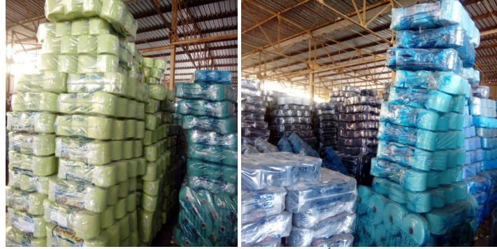
شكل (11) كونات بألوان ونمر مختلفة ناتجة من العوادم النسيجية
